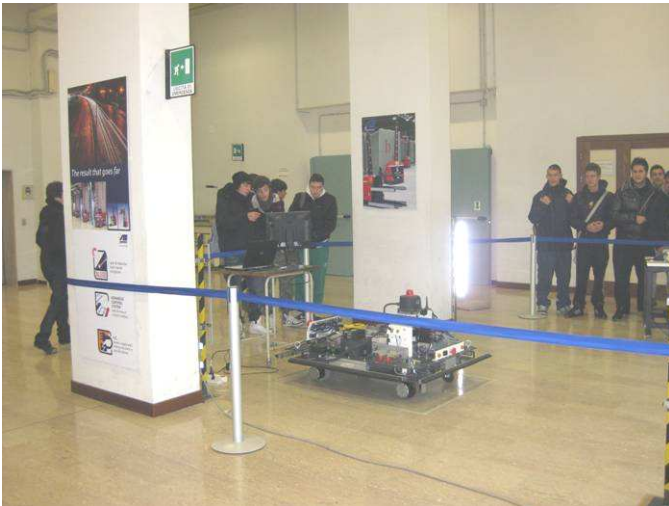
Veicolo a guida automatica AGV con guida laser della ditta SITI-BT GROUP Formigine (Mo) esposto in mostra nella sede ITIS "Corni", Largo Moro.
