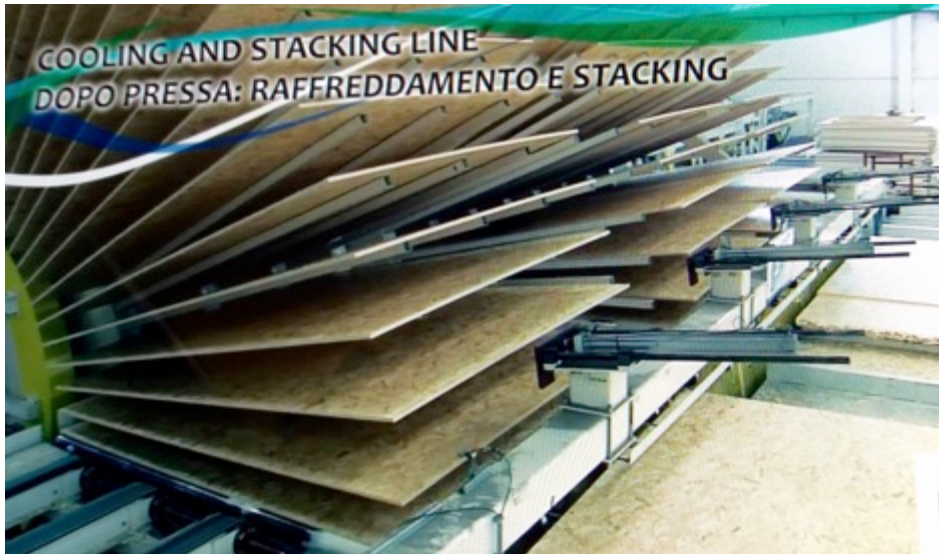
I pannelli di legno nel dopo-prensa per la fase di raffreddamento.
