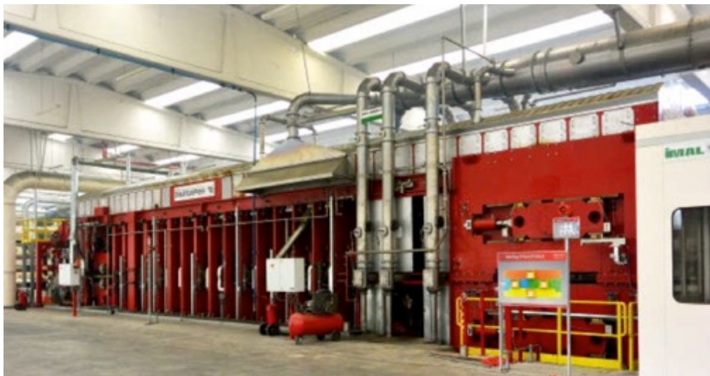
Pressa continua IMAL che riduce del 30% i tempi di pressatura del prodotto.
