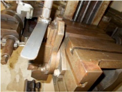
Particolari della limatrice arrugginiti
