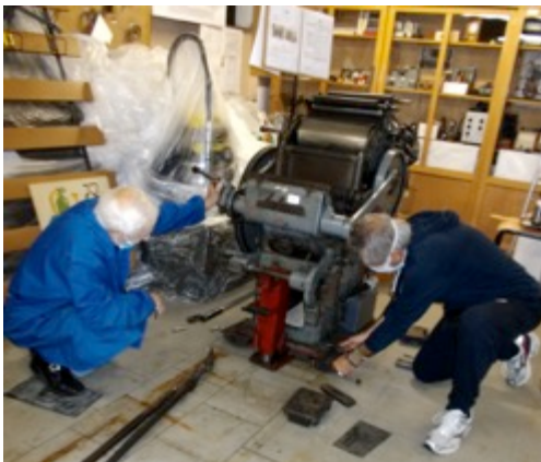
A sx. Giorgio Ansaloni e Dario Piretti montano le piattaforme piroettanti per spostare la macchina Ambrosia.
