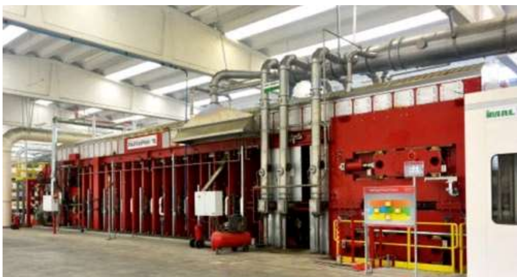
Pressa continua IMAL che riduce del 30% i tempi di pressatura del prodotto.
