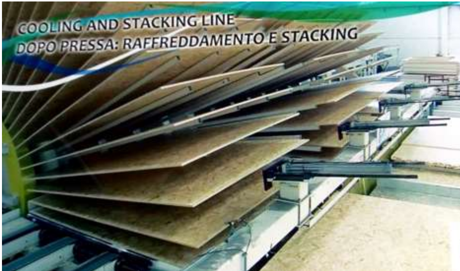
I pannelli di legno nel dopo-presa per la fase di raffreddamento.
